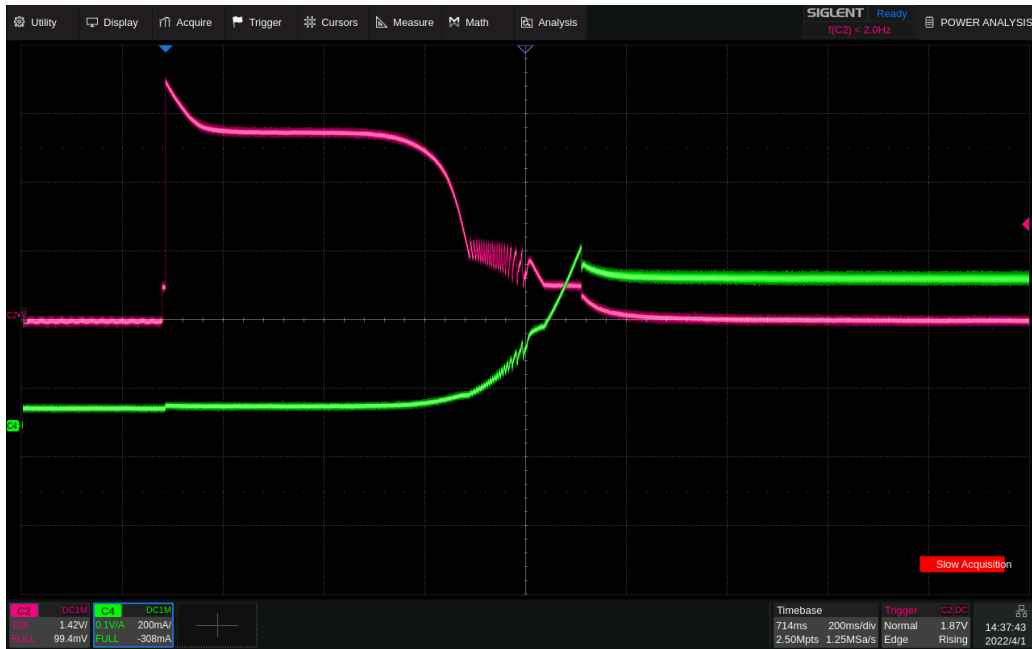
上电时 MOSFET 上的电压和电流波形
