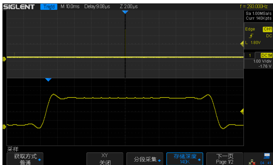
图 18 BURST 信号-浅存储，信号混叠
