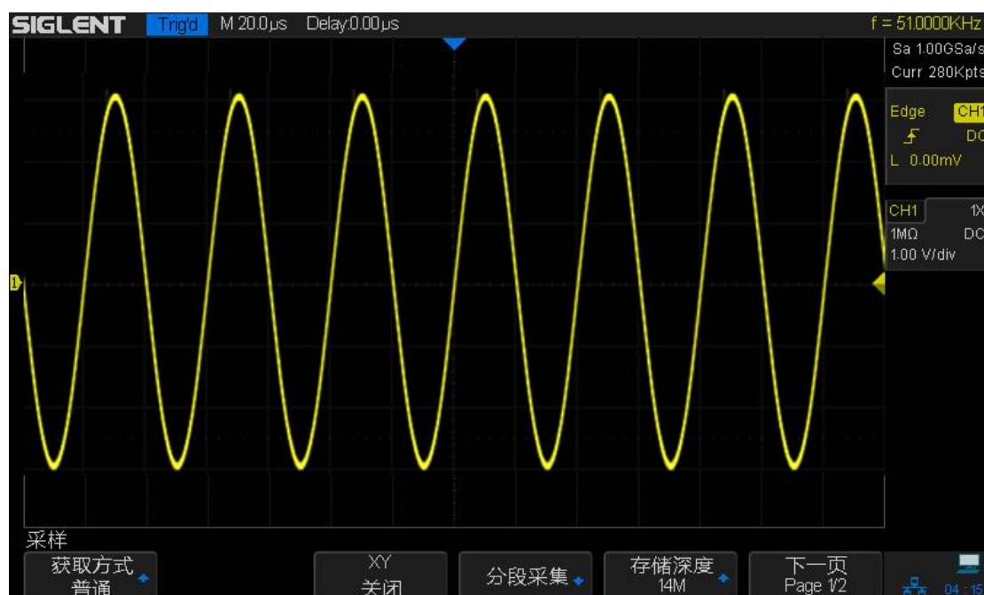
图 26 带毛刺的正弦波（普通模式）
