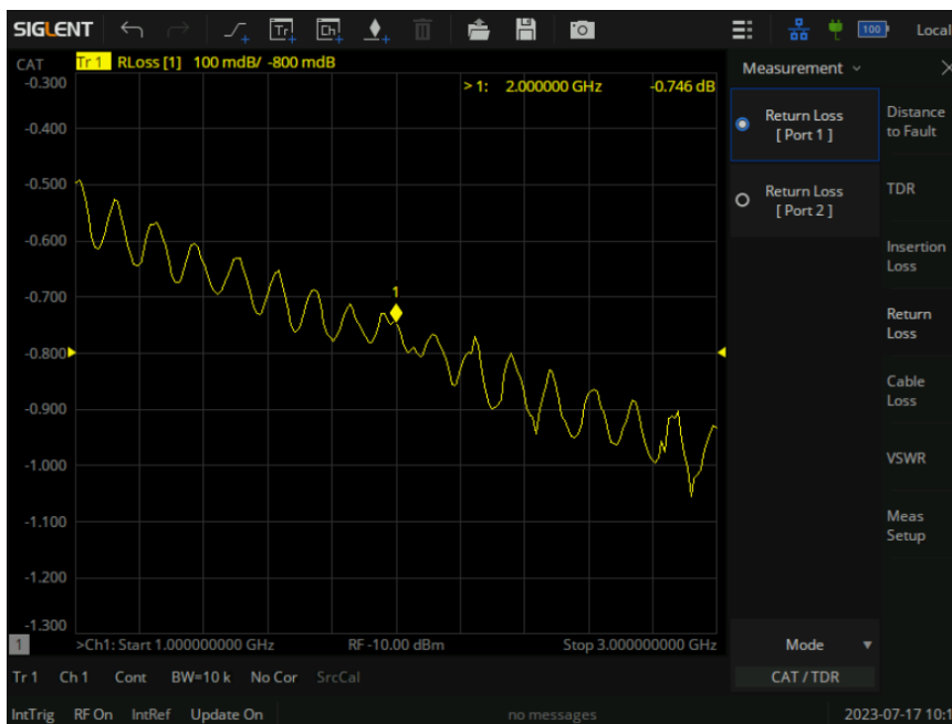
图 11-7 回波损耗测量界面
