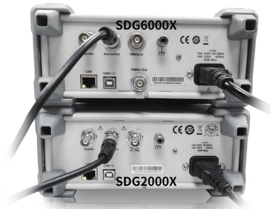
2) 连接 SDG6000X 的 10 MHz Out 接口到 SDG2000X 的 10 MHz In/Out 接口。
