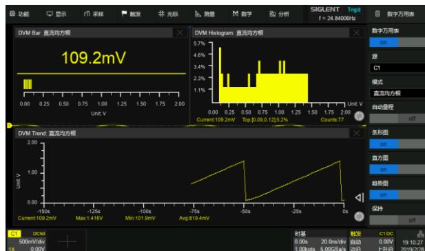
集成 4 位电压表和 7 位频率计，其测量独立于示波器的采集。提供条形图、直方图和趋势图显示
