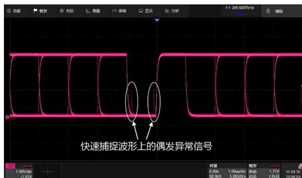
最高 500,000 帧 / 秒的波形捕获率，使示波器能轻松捕获到异常事件或低概率事件
