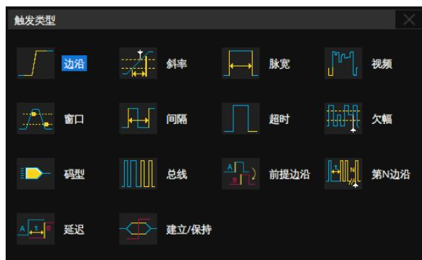
具有丰富的触发功能，包括边沿、斜率、脉宽、视频、窗口、间隔、超时、欠幅、码型、前提边沿、第 N 边沿、延迟、建立/保持和多种总线触发（即：串行触发）
