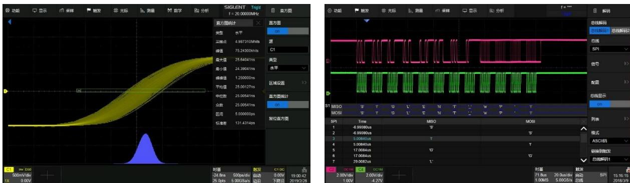
波形直方图功能提供水平和垂直方向上波形概率分布统计
