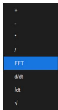
支持加法、减法、乘法、除法、FFT、微分、积分和平方根运算等多种算子。支持公式编辑器进行更复杂的算子嵌套运算
