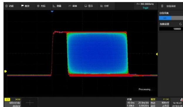
分段采集将波形储存空间分成多段，每段空间存储一个触发帧，最大可以采集 100,000 个触发事件，在 Sequence 周期内可最大限度地降低触发事件之间的间隔时间（小至 2μs），提高对异常事件的捕获概率。Sequence 模式下采集的所有波形段可以一次性全部映射到屏幕上，也可以通过 History 进行单帧回放。
