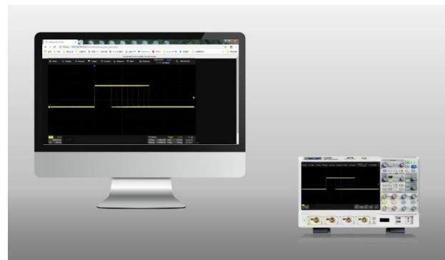
内嵌的网络服务器，支持通过网页远程控制仪器，无需在电脑端安装任何额外的软件
