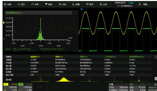
参数统计功能可显示任意参数的五种测量值：当前值、平均值、最小值、最大值、标准差；可同时测量统计五种不同的参数。直方图统计可以直观地显示参数的概率分布情况
