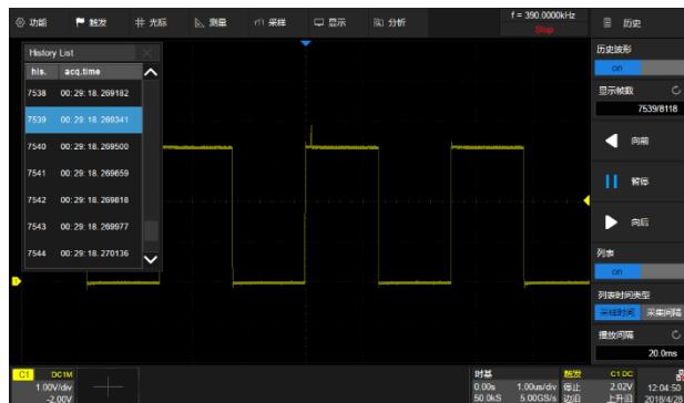
最大可记录 100,000 帧波形；自动实时录制，随时可回放历史波形观察异常事件，并通过光标或测量参数快速定位问题来源；面板上的“History”按键可以快速启动该功能
