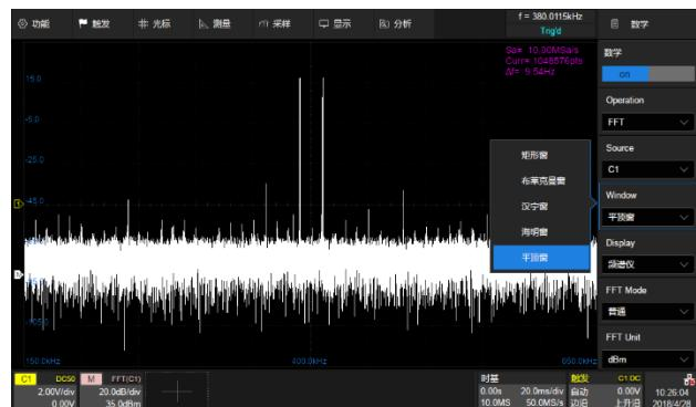
通过硬件加速的 FFT 功能，最大运算点数为 2M 点，在提供优越的频谱分辨率的同时，仍然能够保持较高的频谱刷新率。支持多种窗函数，支持普通、平均、最大值保持等模式
