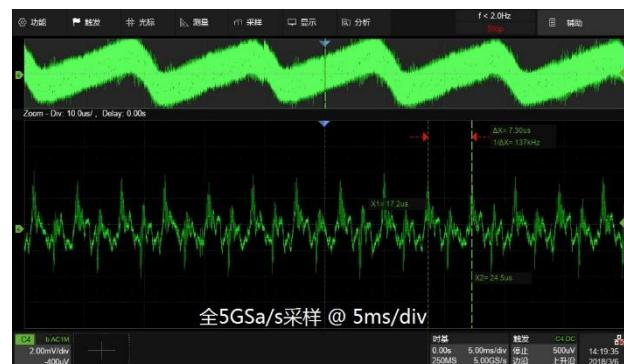
最大 250Mpts/CH 的深存储，用户能够使用更高的采样率捕获更长时间的信号，然后快速放大需要关注的区域，做到整体与细节的兼顾
