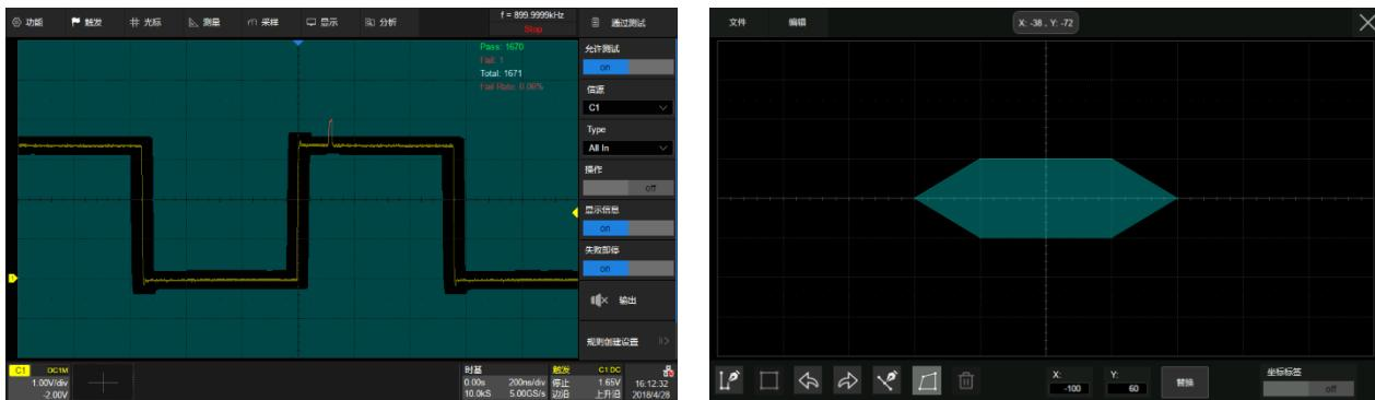
基于硬件的模板测试功能，最高每秒可执行 110,000 次测试。根据用户自定义的垂直和水平容限生成模板，比较被测信号是否触碰模板，如果被测信号触碰模板则测试失败，可以预先设定测试失败时采集停止以及蜂鸣器告警，适用于长期监测异常信号
