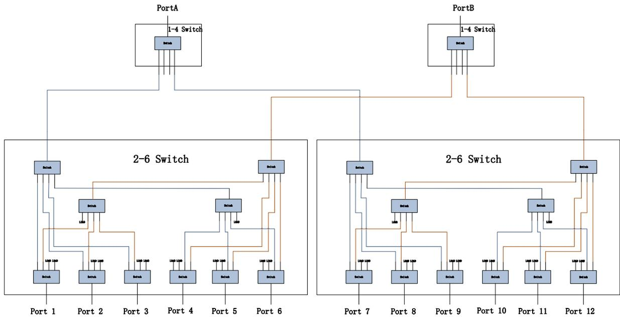
SSM5X22A 型号 (2 端口输入, 12 端口输出)
