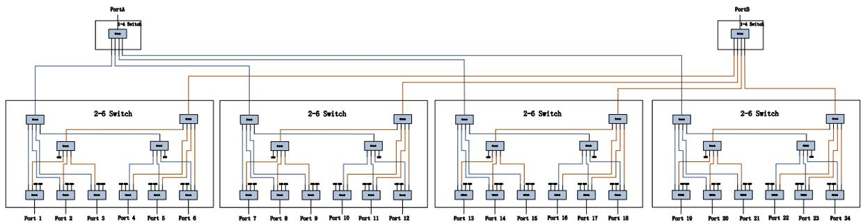
SSM5X24A 型号 (2 端口输入, 24 端口输出)
