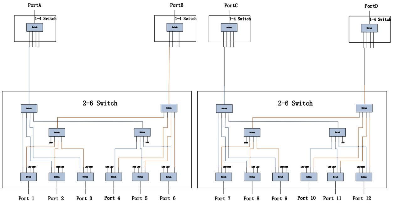
SSM5X42A 型号 (4 端口输入, 12 端口输出)
