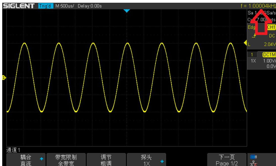
如果有上级的硬件频率计显示<10Hz,一般有两种原因，一种是波形频率小于 10Hz,频率计的不支持测试这么低的频率；还有一种是因为波形没有稳定正确的触发，这个时候硬件频率计是没有办法进行频率测量的，只需将波形正确稳定的触发，硬件频率计即可正常工作。
