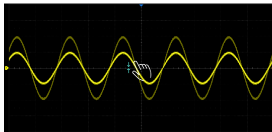
通过垂直方向的两点缩放手势控制波形的垂直档位。当多个通道打开时，控制的是波形离触摸区域最近的通道
