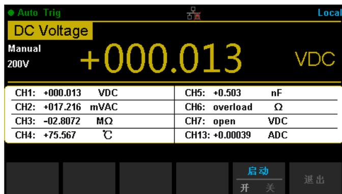
界面上方显示当前扫描通道的功能、档位、数值，下方表格记录本次扫描各通道的测量结果。
