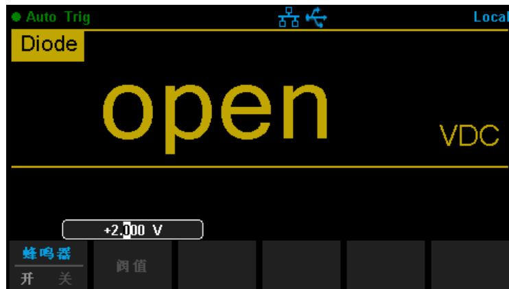
图 2-46 设置导通电压
