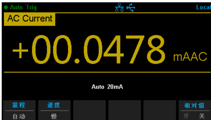
图 2-69 交流电流测量
