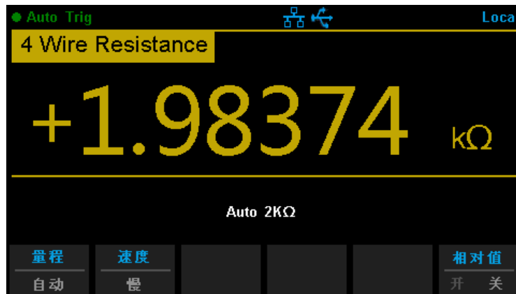
图 2-15 四线电阻测量界面
