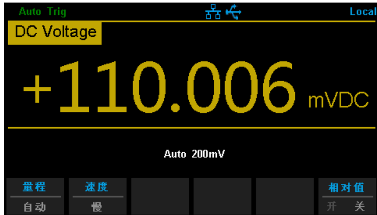
图 2-4 直流电压测量界面
