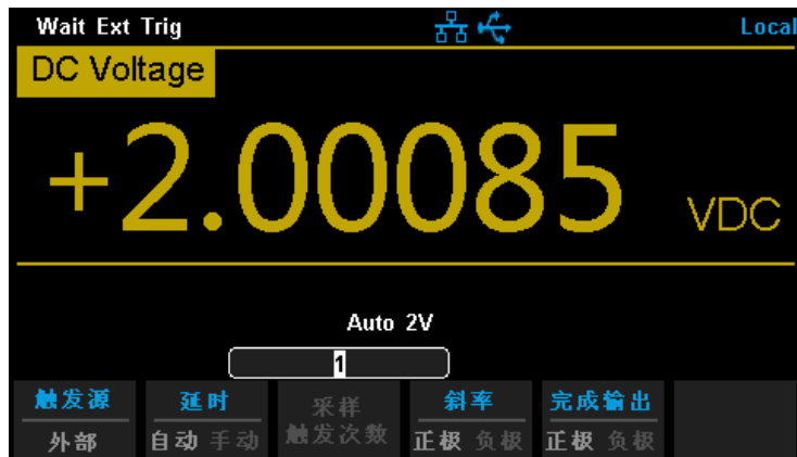
图 2-66 触发源为单次触发的采样
