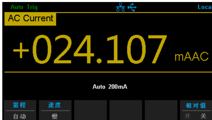
图 2-11 交流电流测量界面
