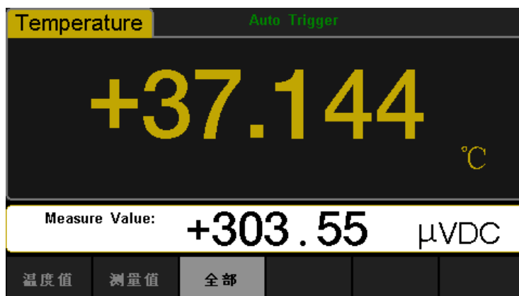
图 2-31 温度测量显示模式选择界面
