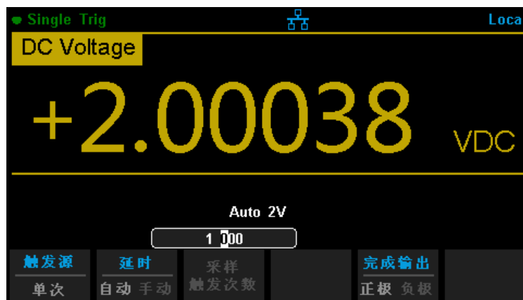
图 2-65 触发源为单次触发的采样
