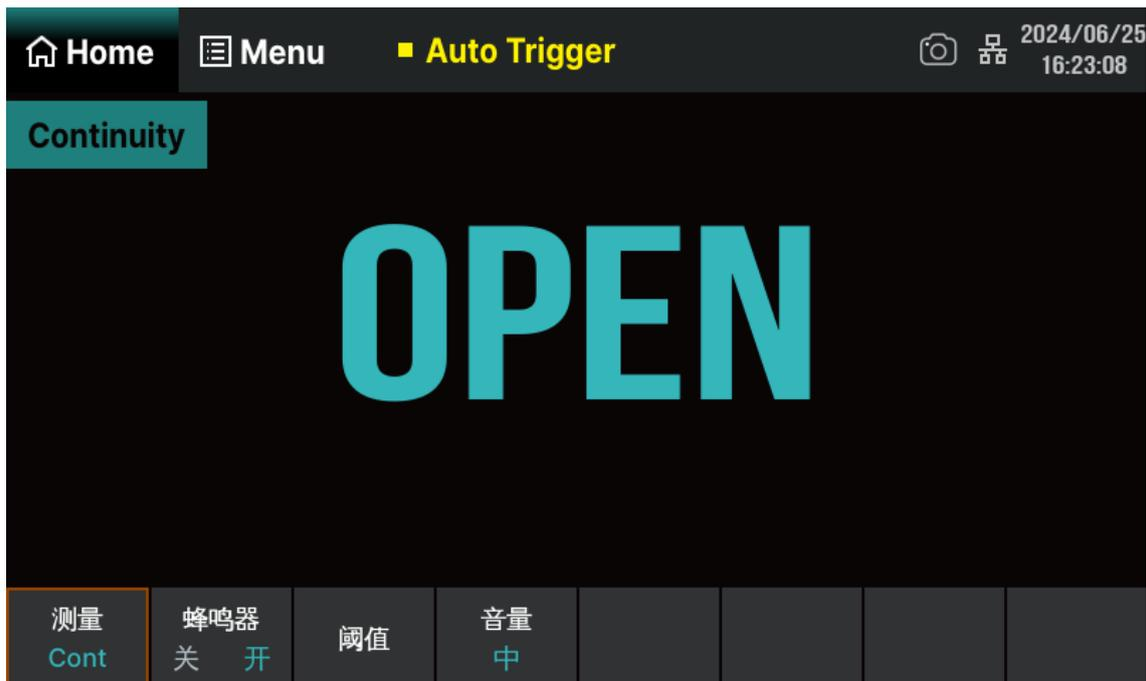
图 7-16 连通性测试界面
