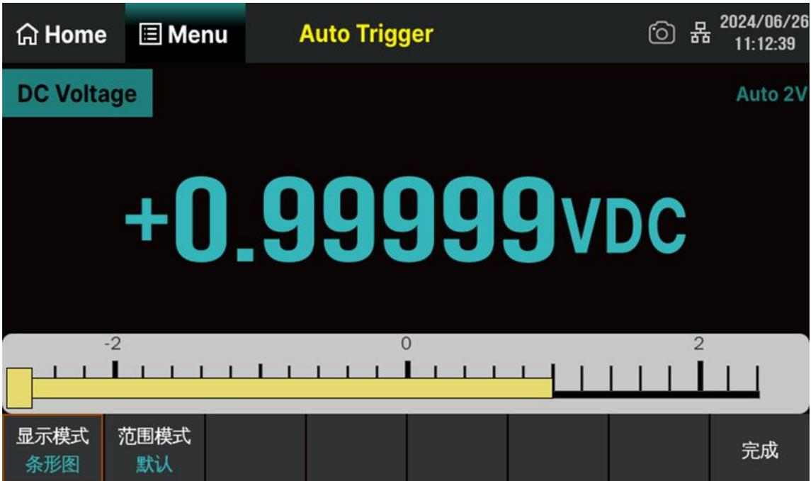
图 7-53 条形图显示界面
