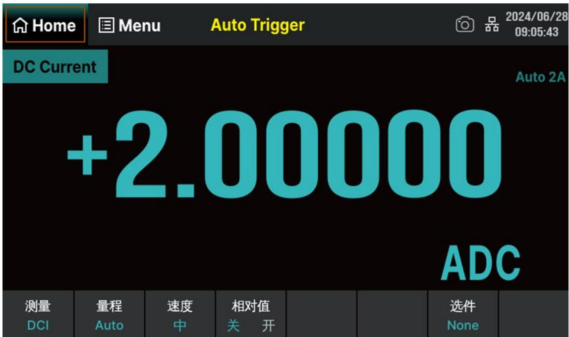
图 7-9 直流电流测量界面
