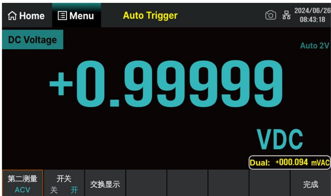
图 7-28 双显示界面（主显示 DCV，副显示 ACV）
