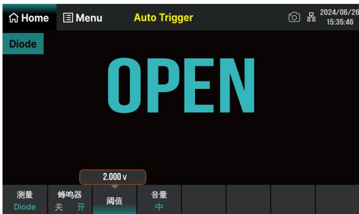
图 7-5 设置导通电压
