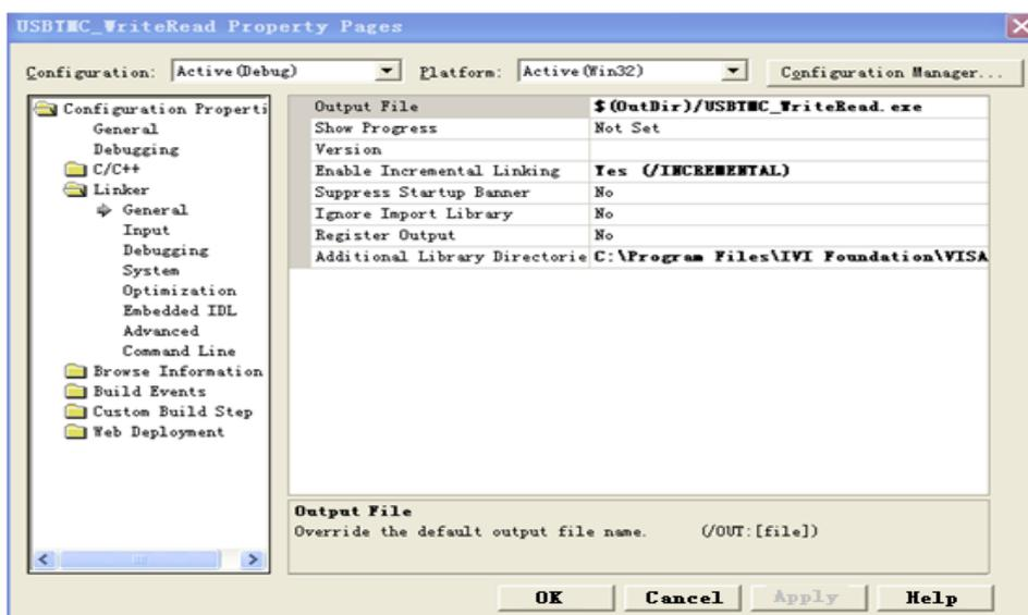
在属性对话框左侧选择“Linker---Command Line”，将“Additional”项的值设置为 visa32.lib，如下图所示：
