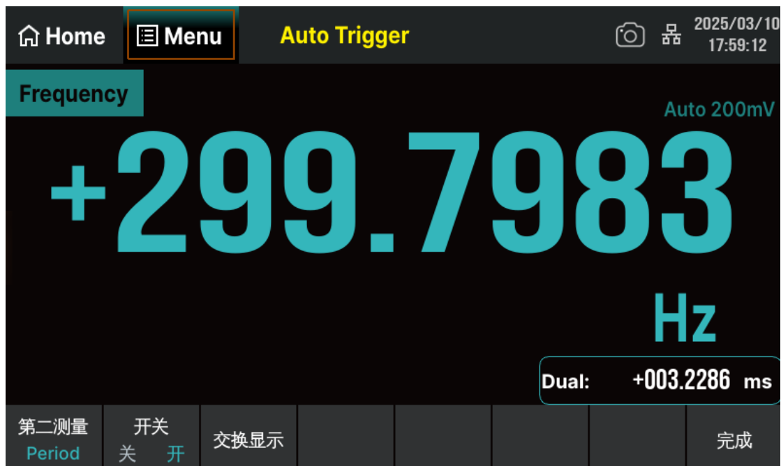
图 7-30 双显示界面（主显示 Freq，副显示 Period）
