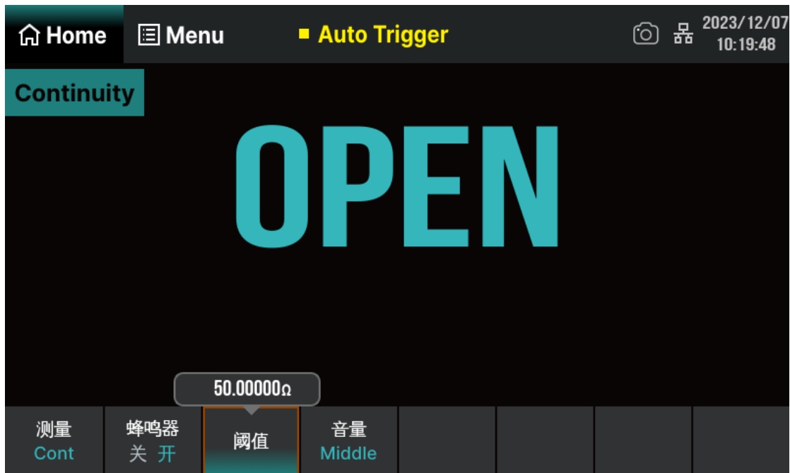
图 7-6 设置短路电阻
