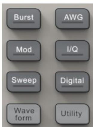
按 Burst/Mod/Sweep 按键可快速打开/关闭脉冲串/调制/扫频功能并跳转至相应的参数设置页面。当功能打开时，对应的按键灯亮；
