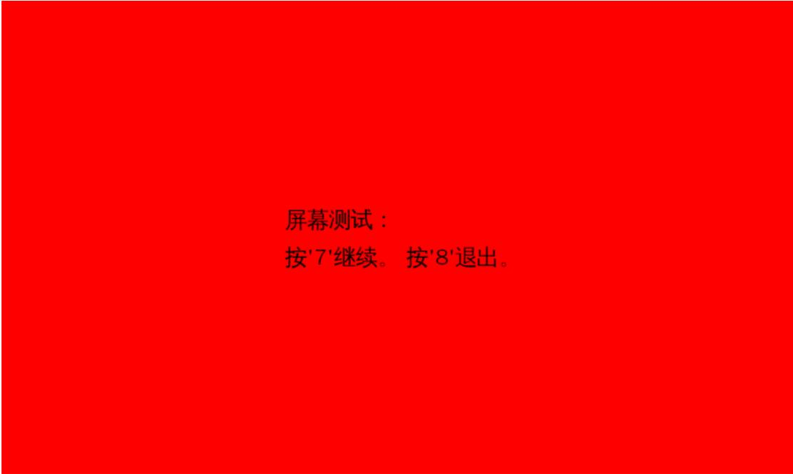
按屏幕提示信息连续按 **7** 键切换至绿色、蓝色屏幕显示模式。在每种颜色对应界面下观察屏幕是否存在严重色差、污点或刮伤等问题。
