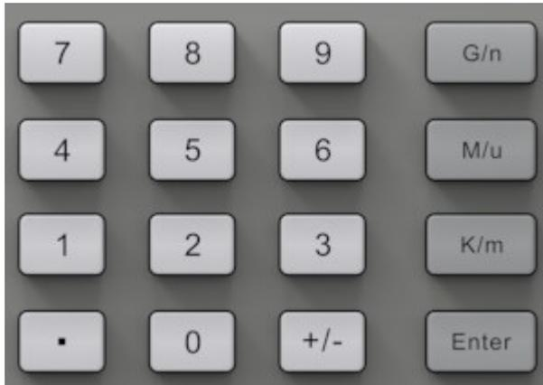
使用数字键盘直接输入选中参数的数值和数量级。例如设置频率为 1 GHz，依次按按键 **1** 和 **G/n** 即可。如果数量级为 1 ( $10^0$ )，可直接按 **Enter** 键
