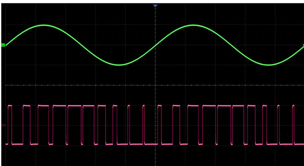
在本例和上例中，当需要对 CH1 的载波进行调制时，CH2 都可以作为调制波的源。区别在于，上例中需要将 CH2 的输出经线缆连接到设备的外调制输入口，而在本例中，无需任何外部连线，调制波和载波直接在设备内部完成调制运算。
