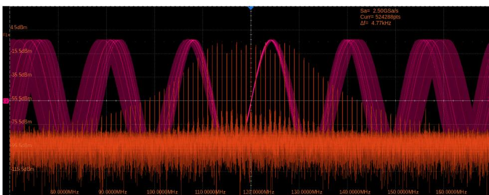
对调制后的信号进行频率测量，绘制出的频率与时间的关系（Track 图）如下，体现出了调制波的频率与形状特性。
