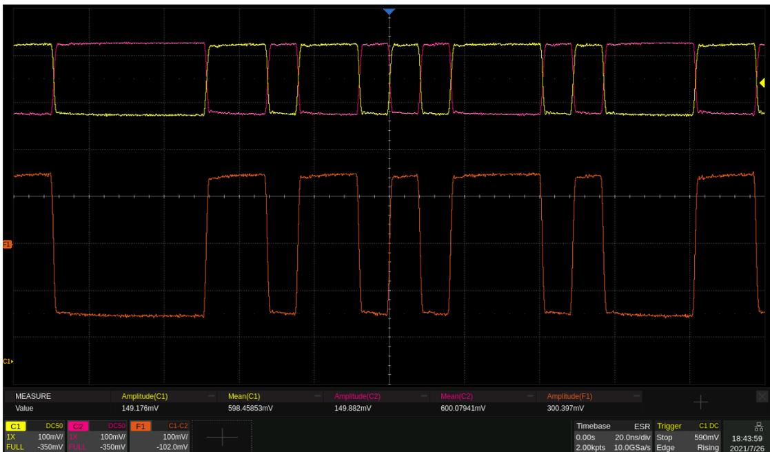
在此应用实例中，由于差分输出的共模偏置范围有限 ( $-1\text{ V} \sim +1\text{ V}$ )，一些共模偏置较大的电平如 LVDS ( $1.25\text{ V}$ )、LVPECL ( $2.0\text{ V}$ ) 无法模拟。此时可以通过两路单端输出互补的方式来模拟差分输出。以下是一个通过两路单端输出模拟一对差分输出的例子。
