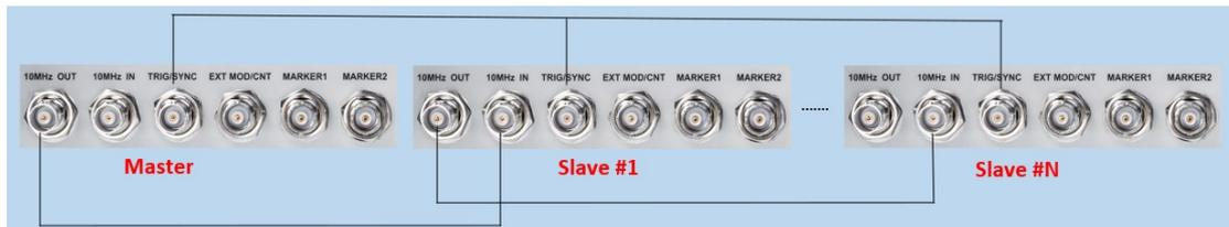
图 17.1 多设备同步的连线示意图
