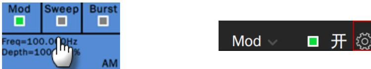
在调制/扫频/脉冲串设置模块的 Mod、Sweep 或 Burst 开关区域点击，可以快速开/关相应的功能：
