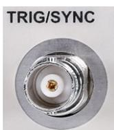
后面板的触发/同步 (Trig/Sync) 端口, 在扫频或 Burst 打开时, 自动设置为触发 (Trig) 输入/输出功能, 其它情况下默认为同步 (Sync) 输出功能。同步信号输出一个 LVTTTL 的周期数字脉冲, 其频率与指定的源同步。
