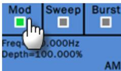
在载波设置页面点击“Mod”设置框内的参数选择区域可快捷选择 Mod、Sweep 或 Burst（下图左），点击参数区域右侧的开关可快捷开/关选中的功能（下图右）：
