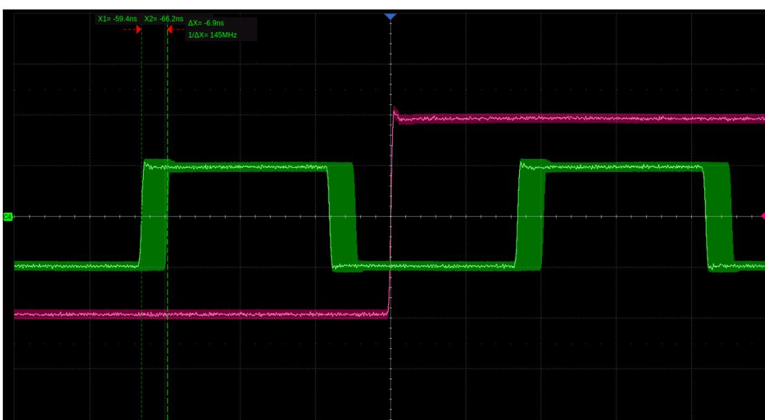
在“相位锁定”模式下，本设备会对成整数倍关系的频率，强制将频率较高的 FTW 赋值为频率较低的 FTW 的整数倍，这样做可能会增大较高频率的输出误差，但可以确保二者之间的相位锁定。以下是本示例中，“相位锁定”模式下两个通道输出经过长时间观察后的情况。可以看到，二者的相位始终是对齐的。
