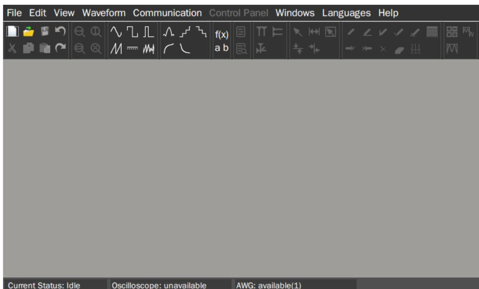
4. 在 EasyWaveX 的操作界面下, 通过 **File** > **Blank Waveform** 新建一个空白波形文件
