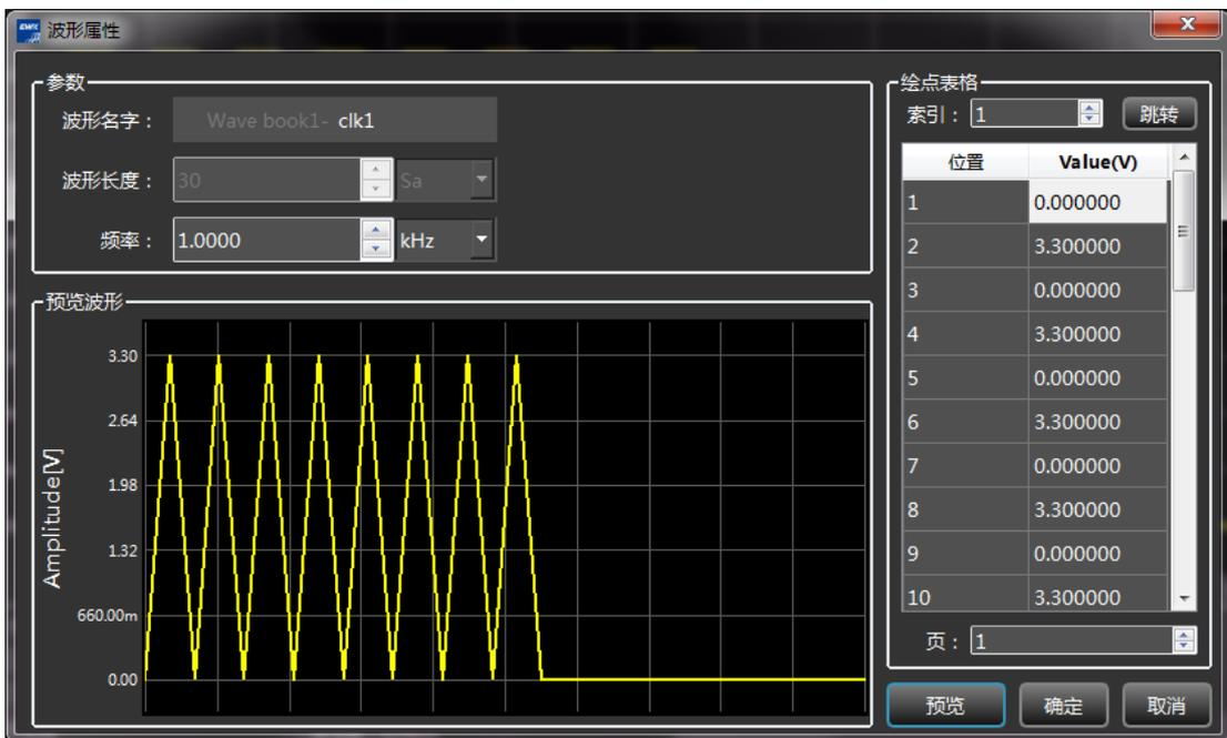
4. 输入完毕后在主程序的波形预览窗口查看波形, 在工具栏的“属性”区域, 选择“视图属性”
