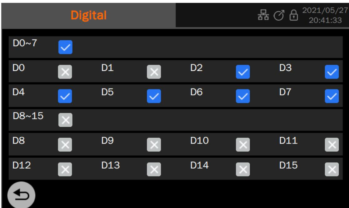
点击 **D0~7** 右侧的复选框可全部打开/关闭 D0~D7 共 8 个通道，也可以在下方单独选择打开 D0~D7 中某些通道；D8~15 的操作同理。
