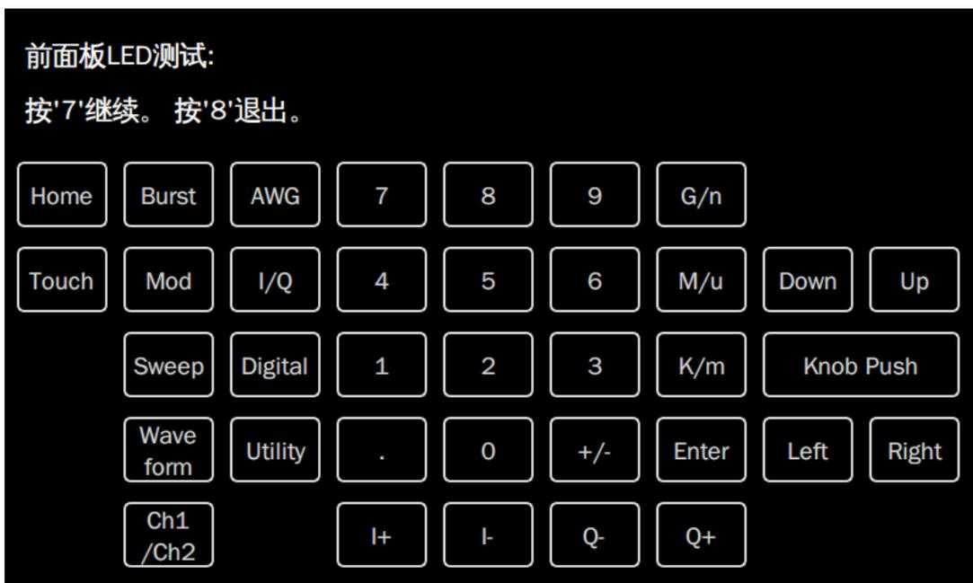
如上图，按照屏幕提示信息按 **7** 键后，前面板上第一个 LED 被点亮，同时屏幕中该键对应位置变亮。继续按 **7** 键可切换至下一按键灯。按照此法连续按下 **7** 键直至所有按键灯均被测试，观察前面板所有按键灯是否能被实时点亮。
