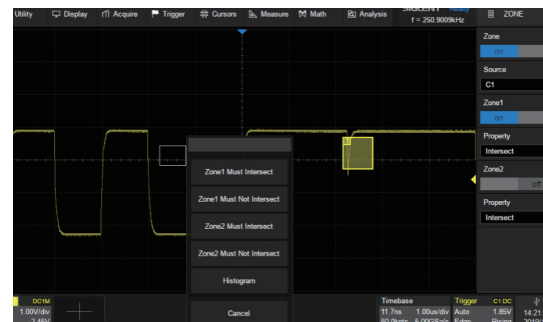
高刷新率轻松捕获偶发信号和毛刺，画定区域，即可设定区域触发
