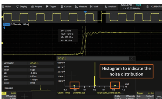
测量参数直方图显示抖动分布
